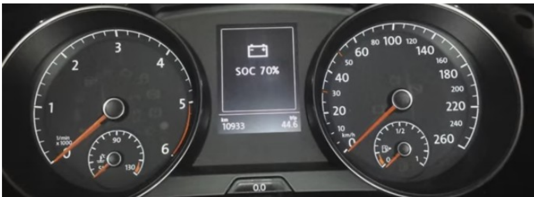
Die State of Charge~ Anzeige (SOC) beim Golf 7 zeigt selten mehr als 70% an
